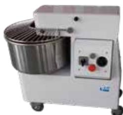
**Q6000** Impastatrice a spirale da 8 kg con timer e kit ruote
