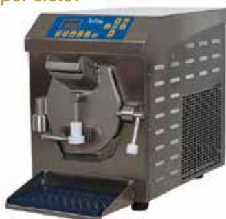
**Q3330** Mantecatore elettronico con lavorazione orizzontale
